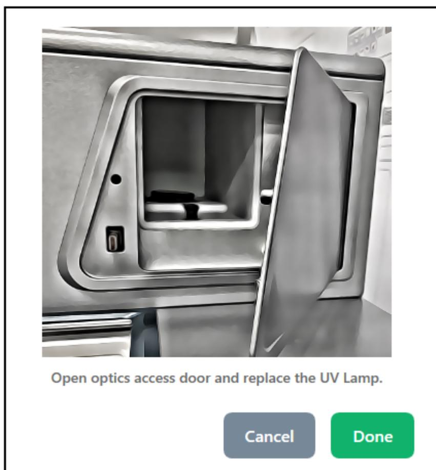
2. システムの左下隅を押して光学コンパートメントのアクセスドアのロックを解除し、ドアを引いて開きます。
