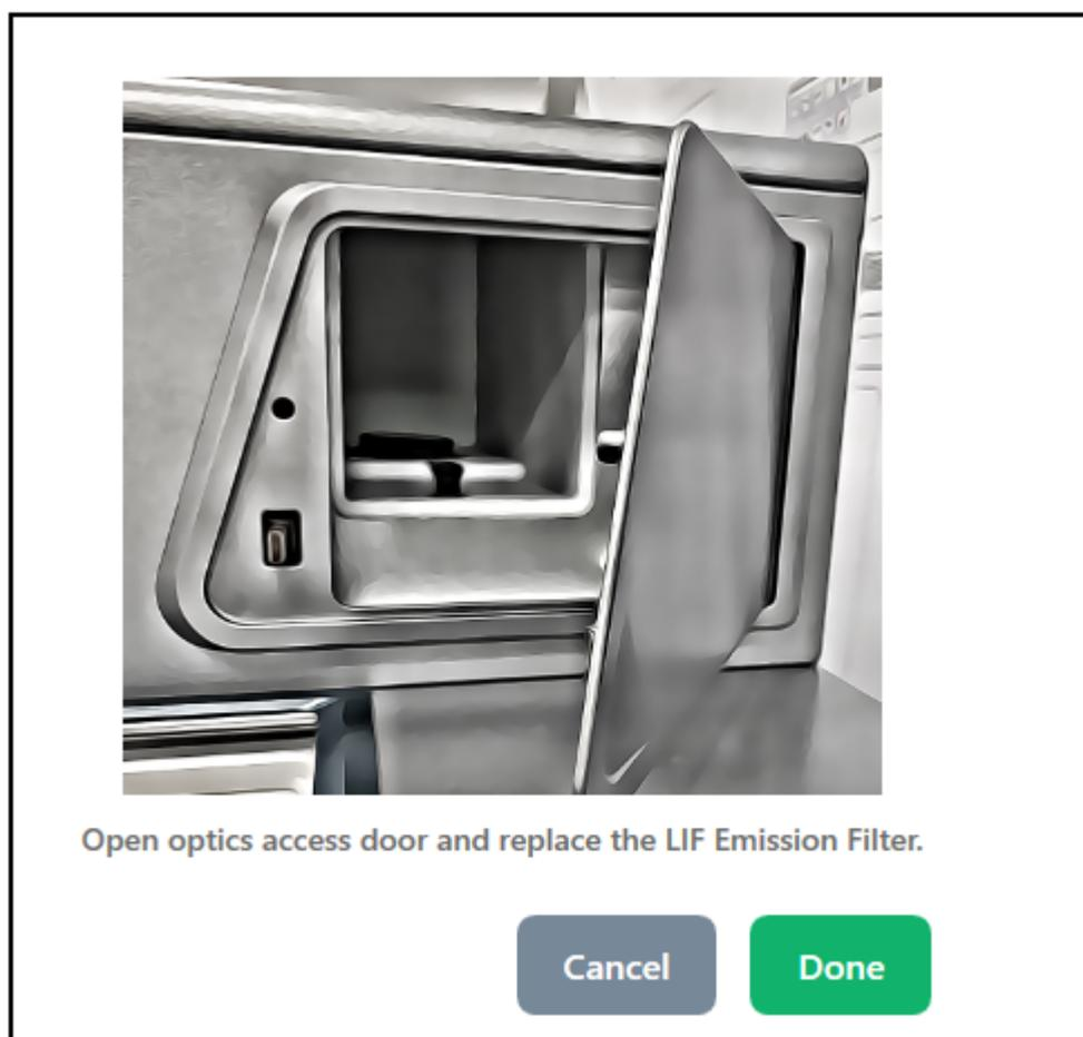
2. 装置の左下を押してロックを解除し、光学コンパートメントのアクセスポアを開きます。
