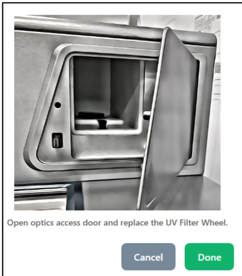
2. システムの左下隅を押して光学コンパートメントのアクセスドアのロックを解除し、ドアを引いて開きます。
