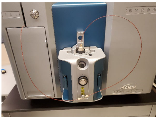
Figura 3-8: Tubo PEEK conectado
