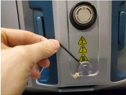
7. 질량 분석계에 이온 소스를 설치합니다. 자세한 정보는 [질량 분석계에 이온 소스 설치](#) 섹션을 참조하십시오.
