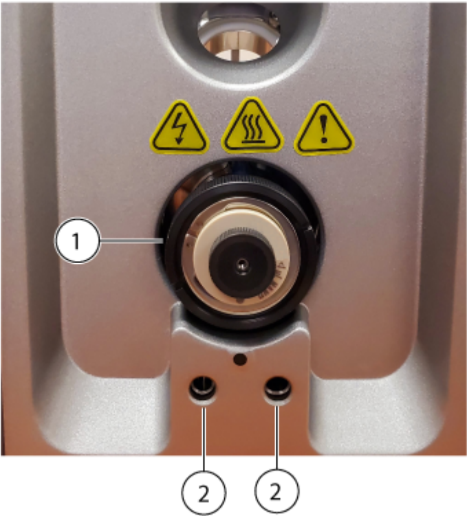
图 3-20 连接至离子源的 Nano 色谱柱加热器
