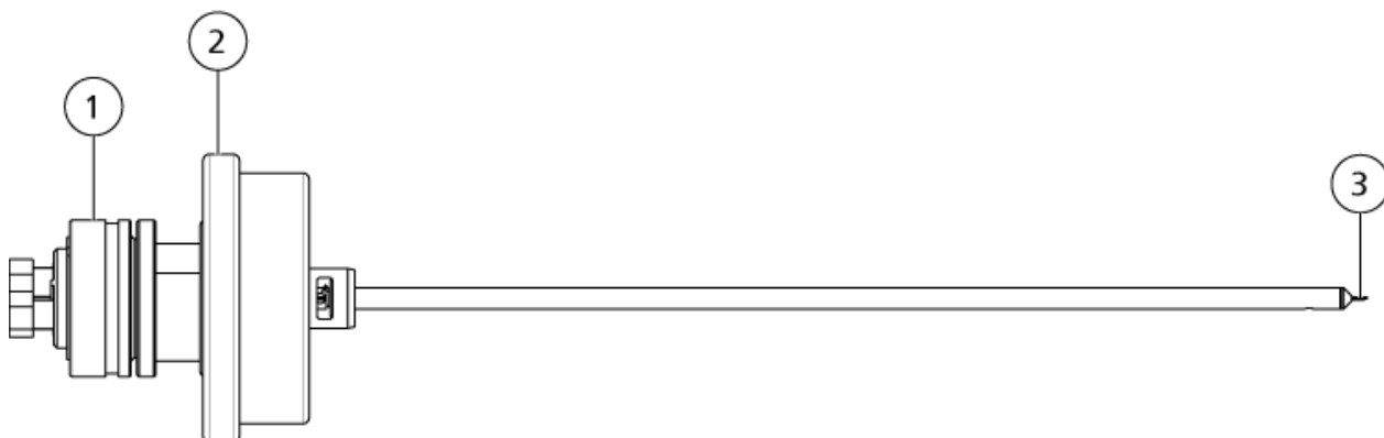
Figura 2-2: Parti della sonda ESI doppia
