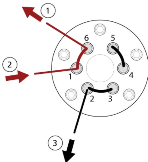
図 3-8 ダイバーターバルブ : ダイバーターモード位置B
