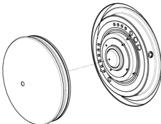
カーテンプレートはオリフィスプレートに配置された3つの球状キャッチで保持されています。
