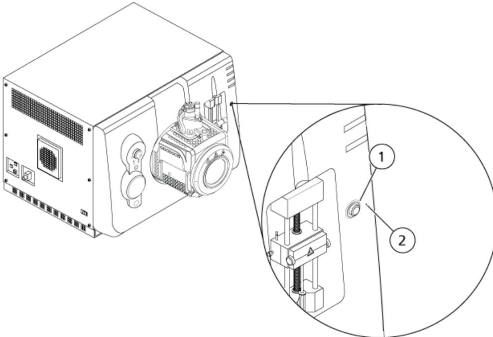
図 3-6 ダイバーターバルブ：インジェクターモード位置B
