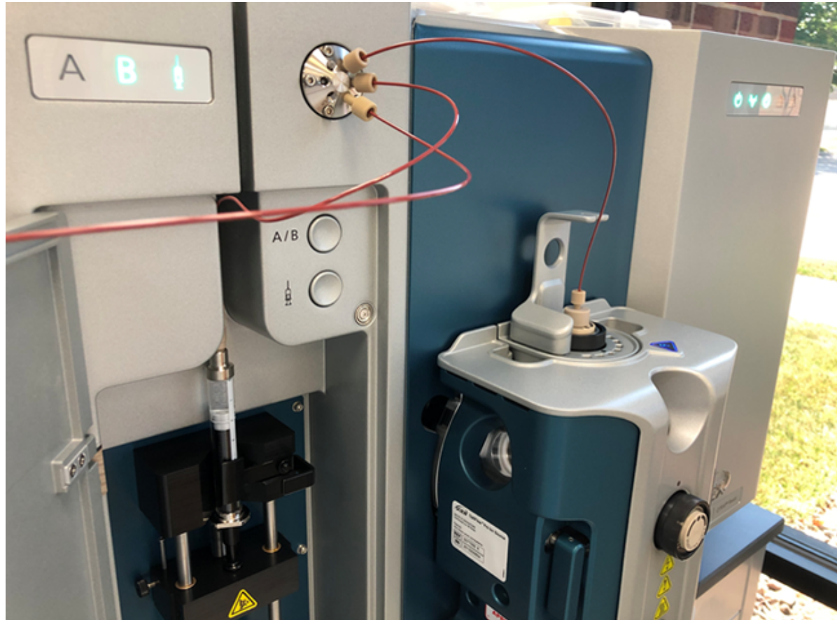
Figura A-1: Collegamenti del tubo della siringa
