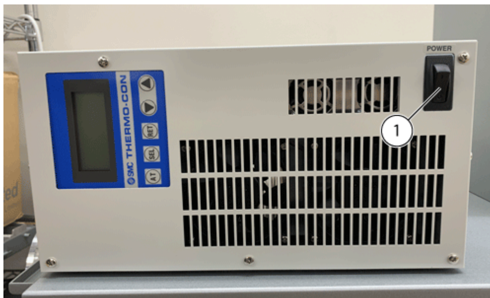
Figura 2-7: Vista frontal: Módulo de refrigeración
