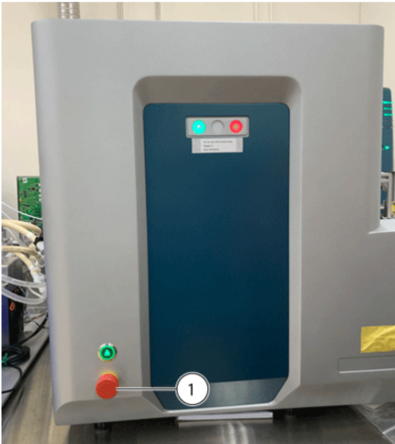
Figura 5-2: Botón de apagado de emergencia en el panel frontal del módulo Echo ® MS+
