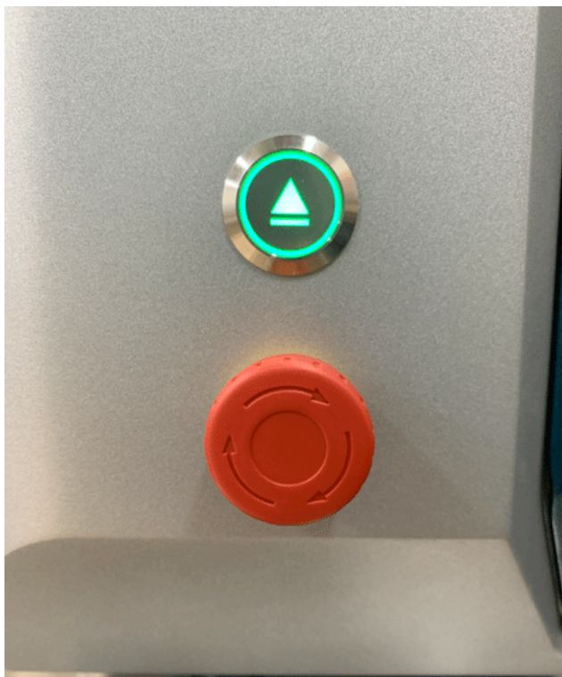
Figura 5-5: Ruotare il pulsante di arresto di emergenza in senso orario
