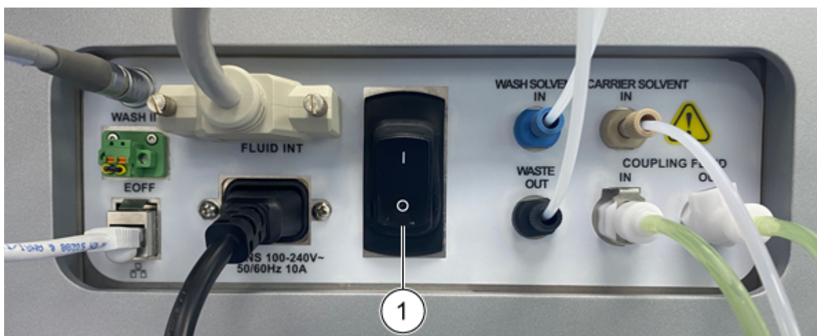
Figura 3-2: Interruttore pratico del modulo Echo® MS+
