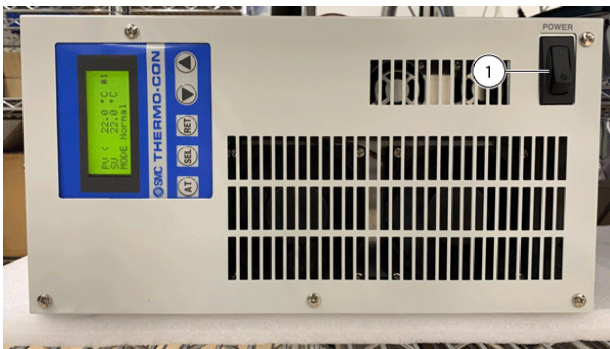
Figura 3-3: Interruttore pratico sul modulo raffreddatore
