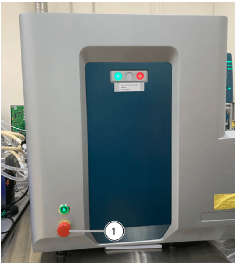
Figura 5-2: Pulsante di arresto di emergenza sul pannello anteriore del modulo Echo ® MS+
