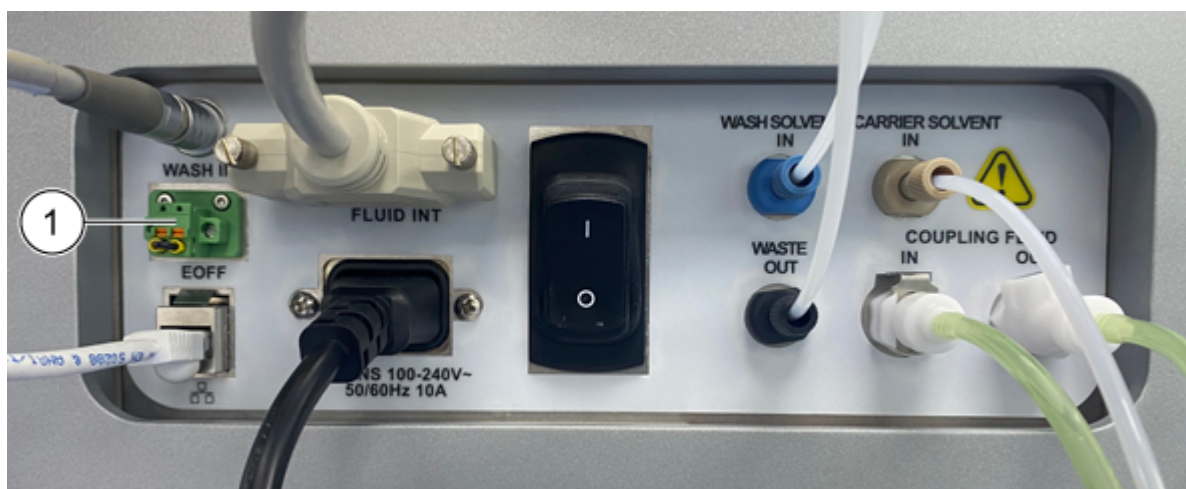
Figura 5-3: Presa e connettore di arresto di emergenza sul pannello posteriore del modulo Echo® MS+
