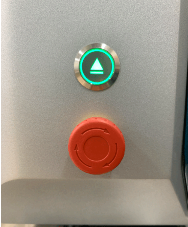
Figura 5-5: Gire o botão de desligamento de emergência no sentido horário
