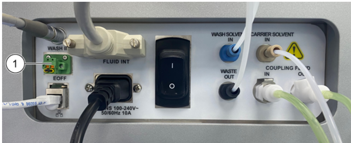
Figura 5-3: Conector e plugue de desligamento de emergência no painel traseiro do módulo Echo® MS+
