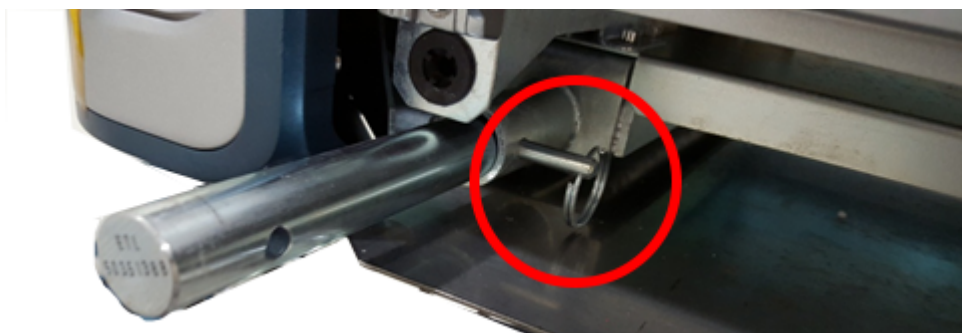
Illustration 6-9 : Barre de levage étendue
